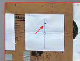
Secondo colpo - POA è al centro del bersaglio. Il POI è 9 cm sopra il primo colpo. 1 MIL = 9,1cm a 91m. La regolazione successiva è di 10 clic (1MIL) sulla derivazione a destra.
