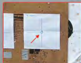
Viene eseguito il primo colpo. Quindi, viene eseguita una regolazione di 10 clic (1MIL) sull'elevazione.
