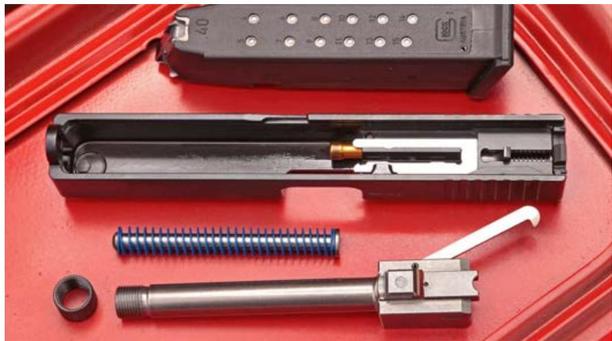
Durch einen Rückstoßverstärker funktioniert das Uhl-System trotz einteiligem und entsprechend schwerem Stahlschlitten auch mit Standardmunition in .22 l.r.
