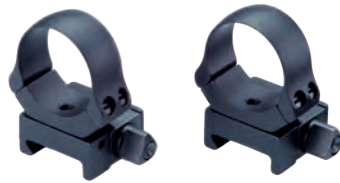
Aufkippmontage mit federnden Gegendruck-Klemmschiebern und schräggeteilten Ringen.
