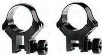
Aufschubmontage aus Stahl mit federnden, einstellbaren Gegendruck-Klemmschiebern; ohne Support. Bauhöhe: 20 mm
