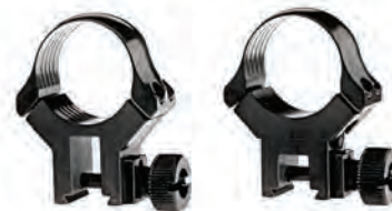
Aufschubmontage aus Stahl, mit federnden, einstellbaren Gegendruck-Klemmschiebern; mit Support. Bauhöhe: 20 mm
