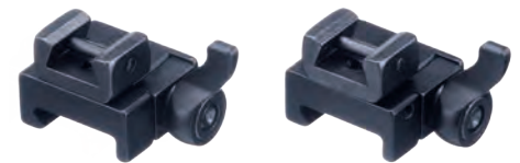
Aufkippmontage mit federnden Gegendruck-Klemmschiebern u. 70°-Aufnahmeprismen für Zielfernrohre mit Mittelrohrschiene.
