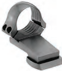
Vordere Klemmringe verlängert, ohne Durchsicht. Gesamtlänge: 45 mm, Ringbreite: 15 mm, Bauhöhe: 12 mm
