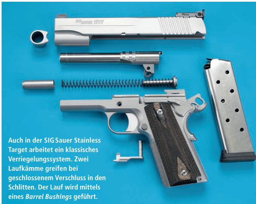
Auch in der SIG Sauer Stainless Target arbeitet ein klassisches Verriegelungssystem. Zwei Laufkämme greifen bei geschlossenem Verschluss in den Schlitten. Der Lauf wird mittels eines *Barrel Bushings* geführt.
