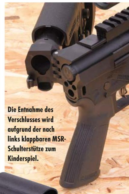
Die Entnahme des Verschlusses wird aufgrund der nach links klappbaren MSR-Schulterstütze zum Kinderspiel.
