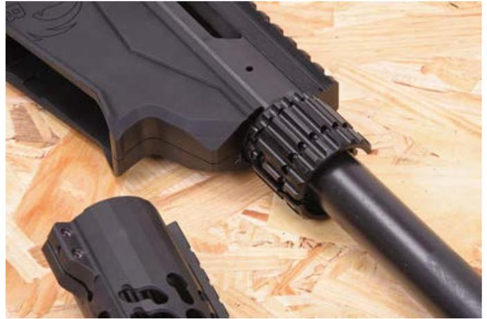
Entfernter Samson Evolution AR-Handschutz und sein verbindendes Befestigungselement am Systemkasten im Detail.
