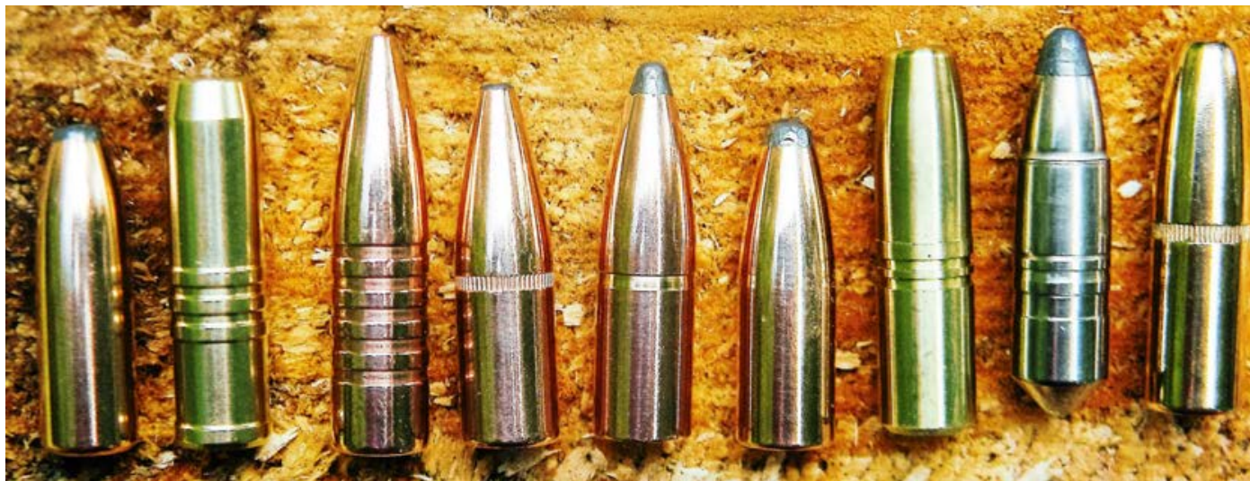
Getestete Geschosse in der Schwergewichtsklasse (von links): 286 Grains Norma Oryx, 280 Grains Cutting Edge Bullets Safari Solid, 286 Grains Barnes TSX, 286 Grains Hornady Teilmantel, 286 Grains Nosler Partition, 270 Grains Speer HotCor, 286 Grains Nosler Solid, 293 Grains Brenneke TUG und 300 Grains Hornady DGS Solid.
