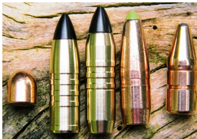
Getestete Geschosse in der Leichtgewichtsklasse (von links): 95 Grains Speer Vollmantel-Rundkopf (für Pistolenkaliber 9 mm Makarow), 200 Grains FB und 210 Grains ESP Raptor von Cutting Edge Bullets sowie 220 Grains Lapua Naturalis und 225 Grains RWS Doppelkern.
