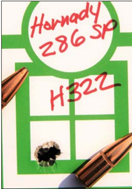
Ähnlich enger Ein-Loch-Streukreis mit Handlaborierung, bestehend aus 53,5 Grains Hodgdon H322 und Hornady 286 Grains SP-RP-Geschoss.
